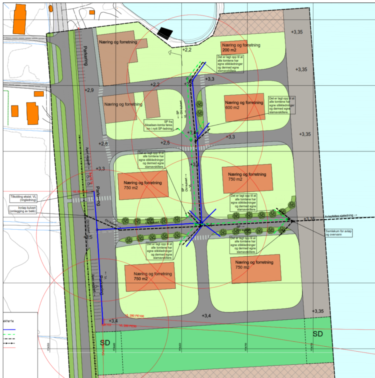
De røde sirklene viser brannvannsdekningen fra brannvannskummer ( R=50\text{ m} ).
